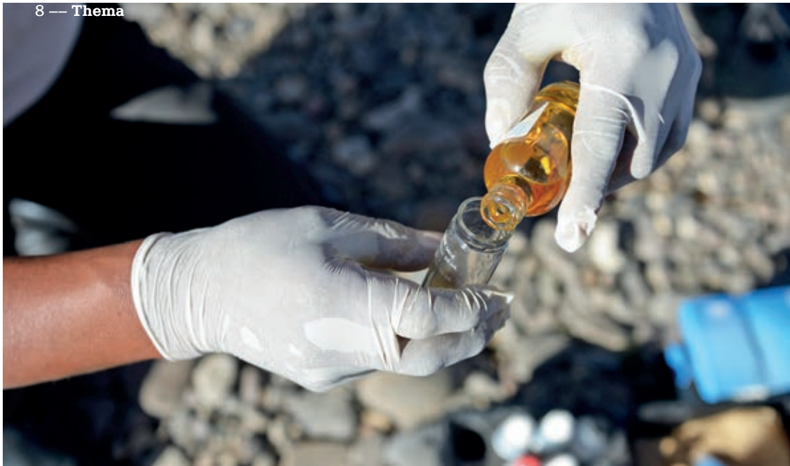
Aus der Wasserprobe werden der PH-Wert und andere Parameter gemessen, die die Güte des Wassers ausmachen und deren Werte als Frühwarnsystem genutzt werden
